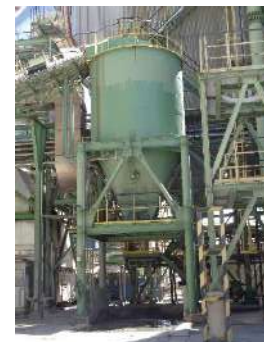
ภาพที่ 2.2-31 ไซโลหรือ Collecting Pit เก็บถ่านแบบปิด
